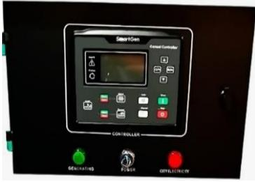
Controlador de falla de red automática para un solo generador, puede monitorear y proteger el generador en funcionamiento todo el tiempo. Tiene una pantalla LCD que muestra claramente el estado del motor. Este controlador incluye siete entradas y seis salidas. Este controlador también se puede programar usando el panel o usando el software de configuration Suite.
