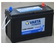
⑧ Batería de arranque
